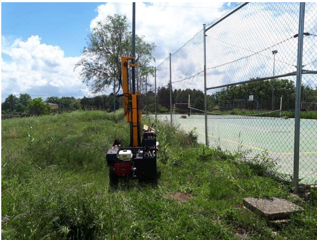
Fotografía 1: Realización de la penetración dinámica continua P-1.
