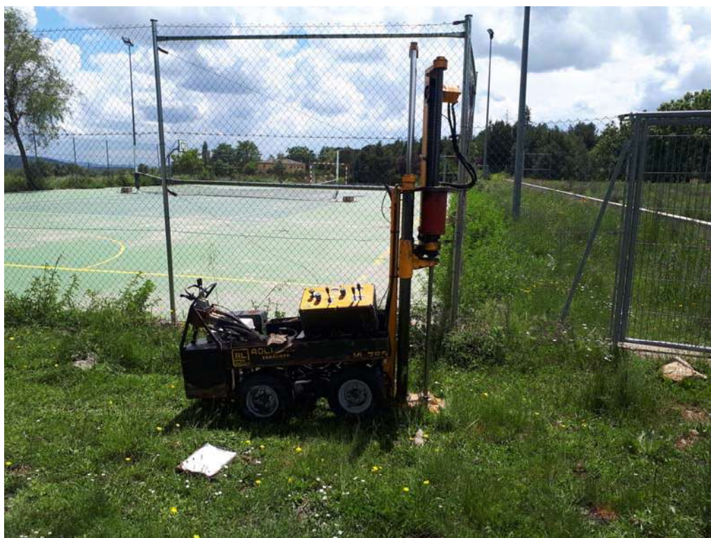
Fotografía 4: Realización de la penetración dinámica continua P-4.
