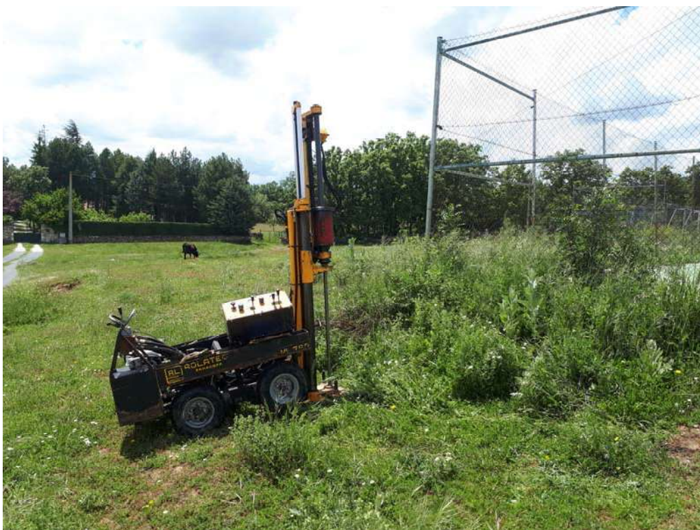
Fotografía 2: Realización de la penetración dinámica continua P-2.
