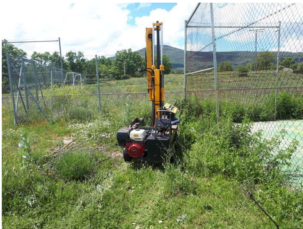
Fotografía 3: Realización de la penetración dinámica continua P-3.
