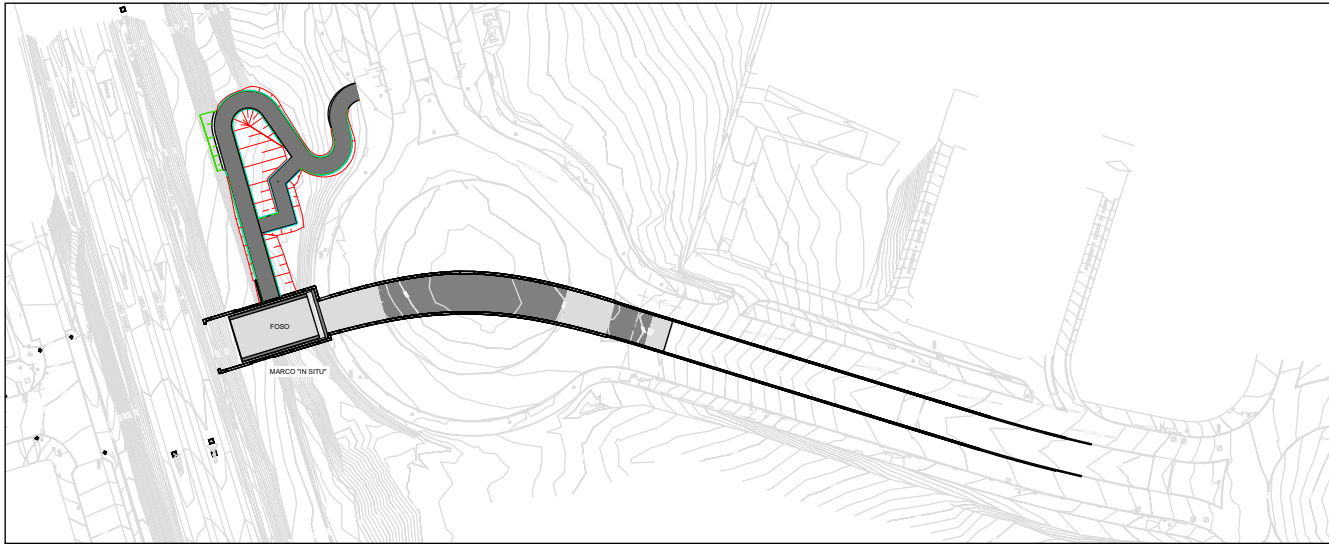
FASE 5 : MARCO EJECUCIÓN LOSA DE DESLIZAMIENTO CONSTRUCCIÓN "IN SITU" DEL MARCO EN SU POSICIÓN INICIAL
