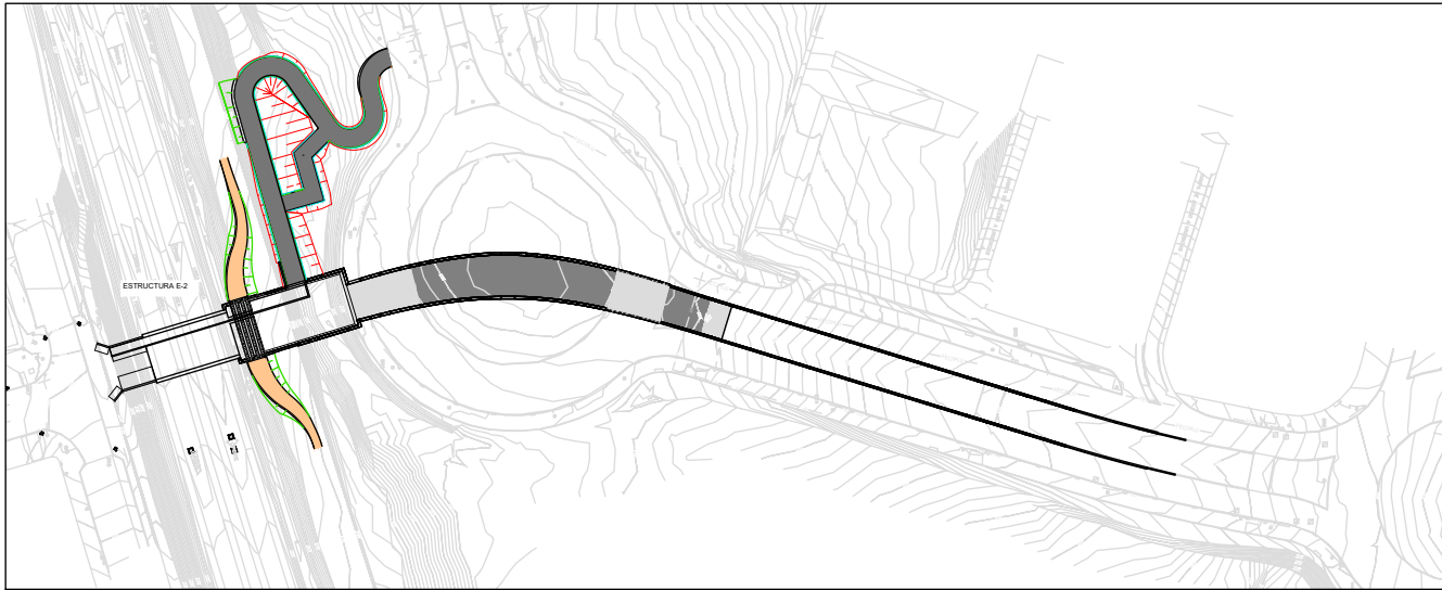
FASE 9 : ESTRUCTURA E-2 CONSTRUCCIÓN DE CABEZALES SOBRE PANTALLAS COLOCACIÓN DE VIGAS Y HORMIGONADO DE LOSA EJECUCIÓN CAMINO DE SERVICIO ADIF
