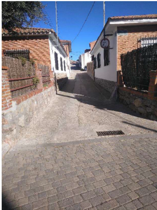
Calle Zorrea. Inicio desde la calle Verdinal. Firme de hormigón con parches debidos a la ejecución de zanjas.
