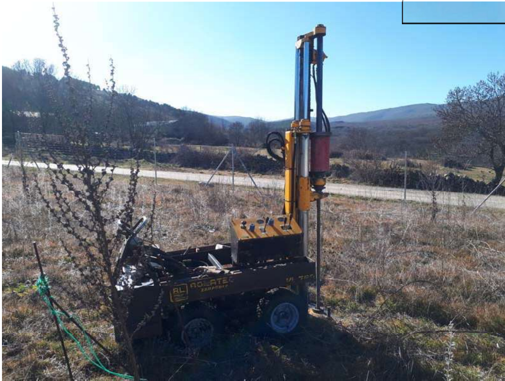
Fotografía 3: Realización de la penetración dinámica continua P-3.
