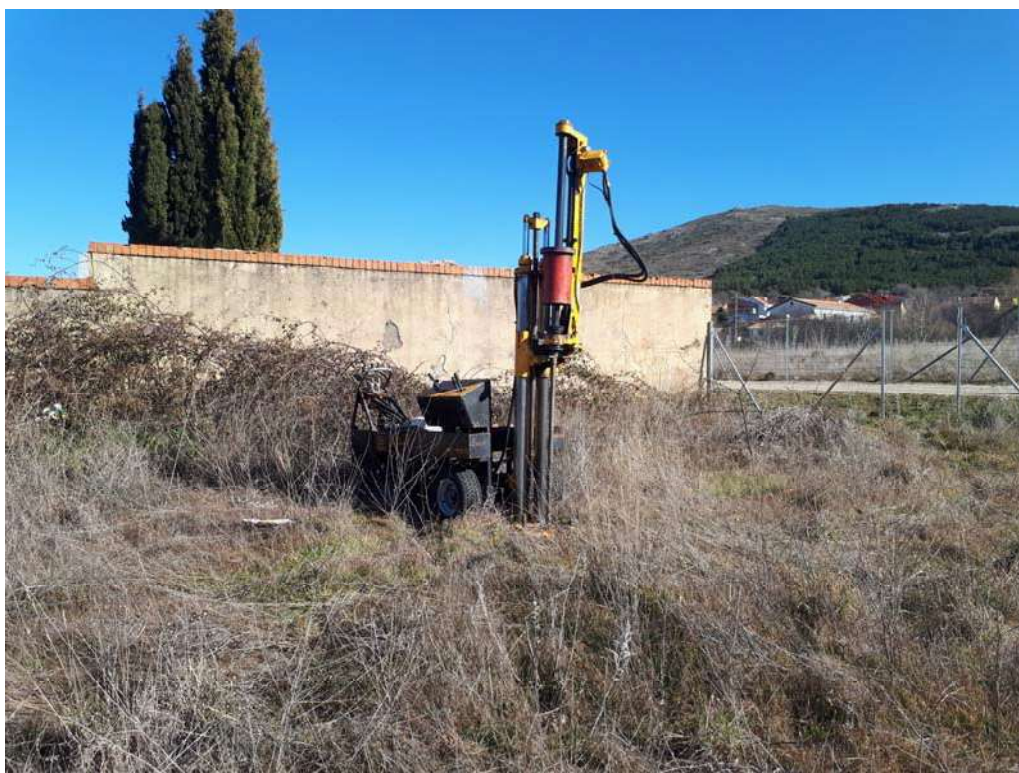
Fotografía 1: Realización del sondeo mecánico S-1.
