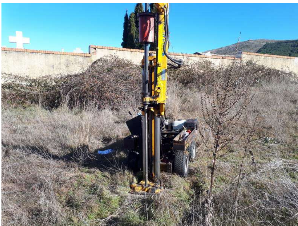
Fotografía 2: Realización de la penetración dinámica DPSH, P-1.
