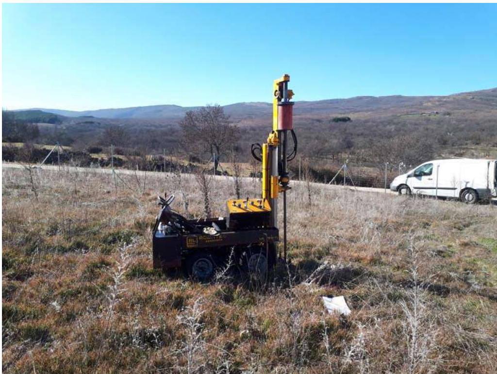
Fotografía 2: Realización de la penetración dinámica continua P-2.
