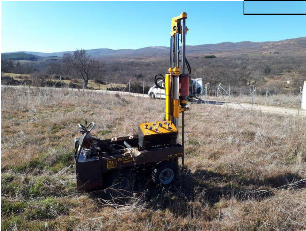
Fotografía 1: Realización de la penetración dinámica continua P-1.
