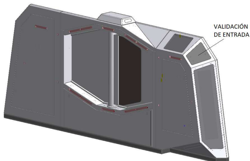
Figura 62: Ubicación del lector de validación de entrada
