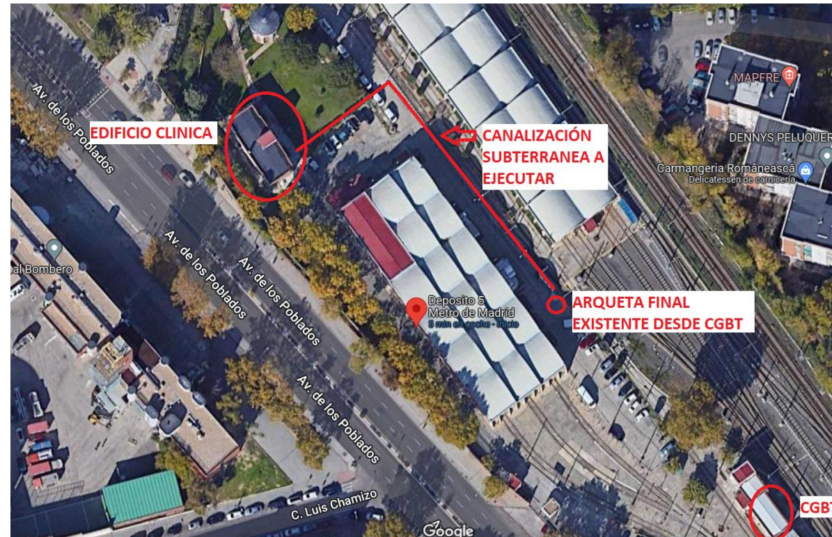
Fig. DE.5 – Plano de canalización a ejecutar en depósito 5
