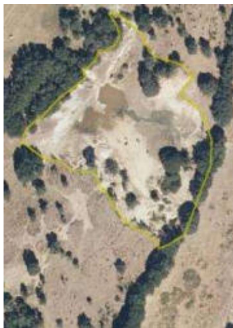
Figura 32 Zona activa de erosión, la entrada de un pequeño cauce temporal desde el sur provoca la socavación y desmoronamiento de los taludes tal como se aprecia en la imagen. Fuente: Agresta S.C.
