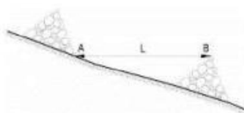
Figura 34 Espaciamiento entre diques de retención (L). La línea A-B marca el punto de máxima elevación de agua. Fuente: Criterios técnicos para el control de cárcavas, DISEÑO DE muros de retención y revegetación de paisajes agrarios. Elaboración a partir de Gray y Leiser (1989)
