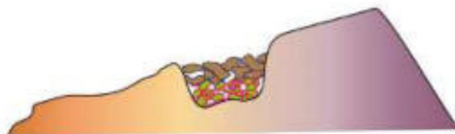
Figura 56 Zanjas de drenaje (quita aguas). Fuente: Proyecto Parque Nacional- RSEA Peñalara
