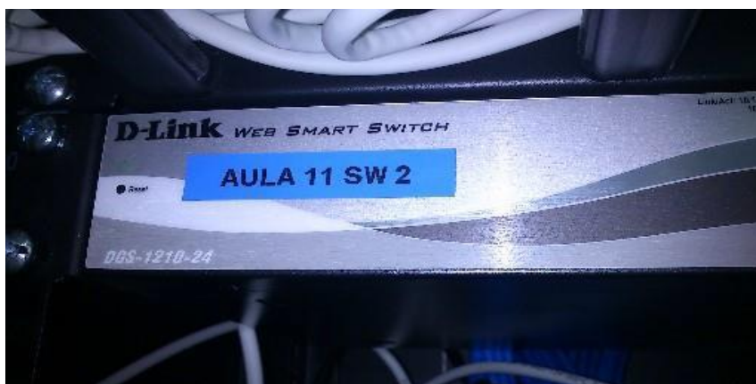
Imagen 5: Switch secundario de un aula
