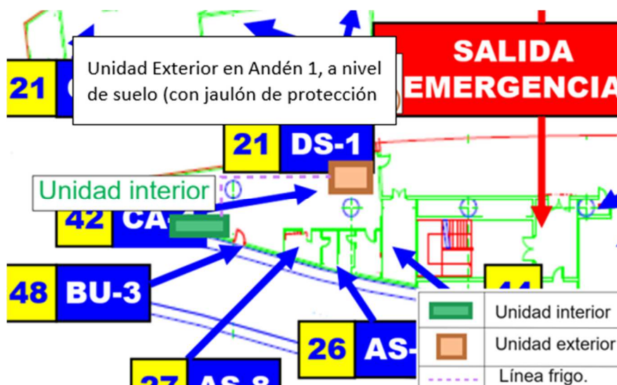
Ilustración 8-12. Esquema de la instalación de climatización. Estación de Tres Olivos.
