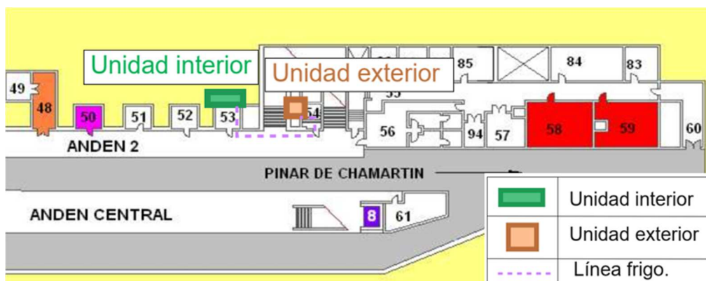
Ilustración 8-27. Esquema de la instalación de climatización. Estación de Argüelles.
