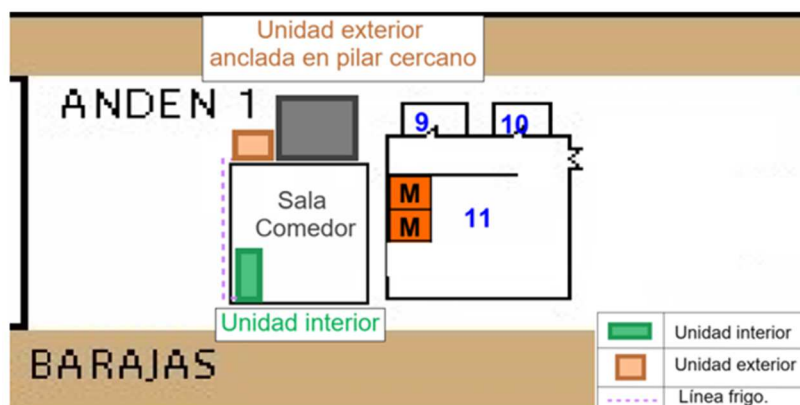
Ilustración 8-4. Esquema de la instalación de climatización. Estación de Aeropuerto T4.
