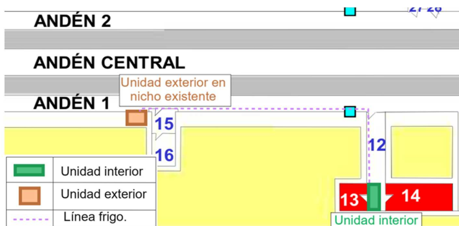
Ilustración 8-46. Esquema de la instalación de climatización. Estación de Laguna.
