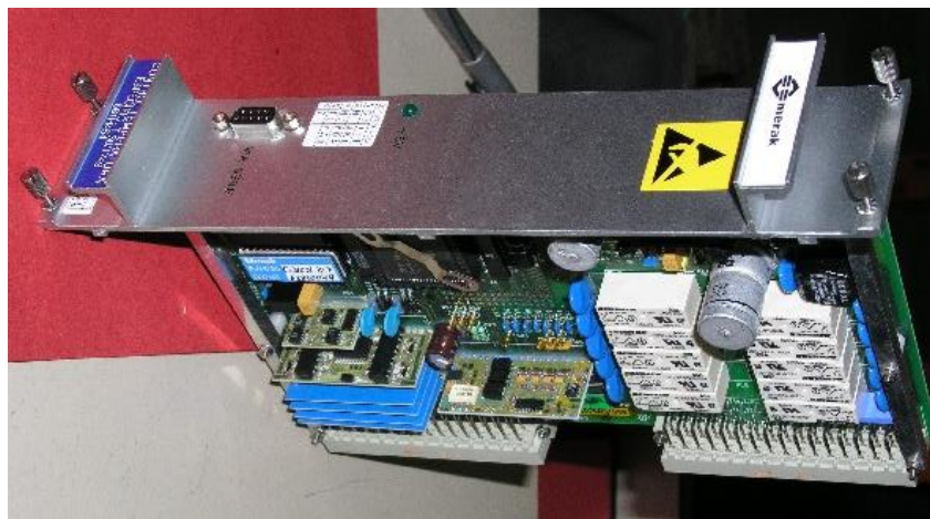
Ilustración 1. Tarjeta de control de los equipos de cofre de conmutación.
