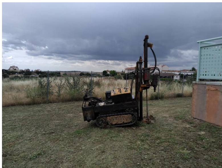
Figura Nº 6.- Trabajos para la realización de la penetración dinámica, tipo DPSH, referida como P-03.
