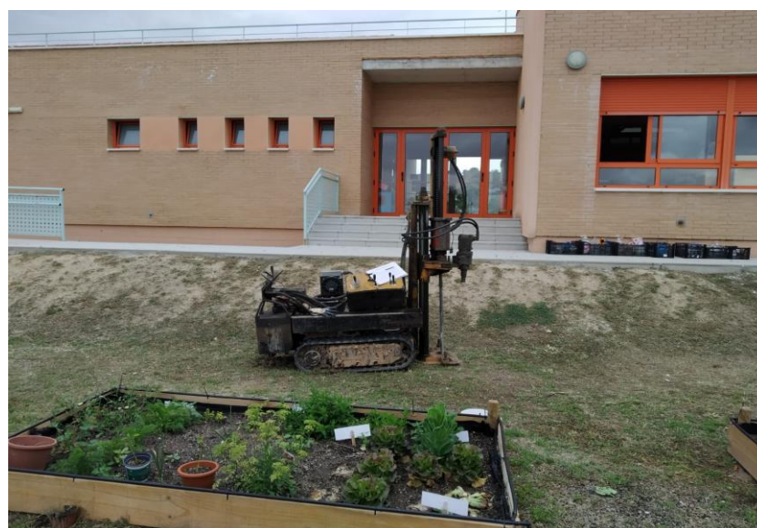
Figura Nº 5.- Trabajos para la realización de la penetración dinámica, tipo DPSH, referida como P-02.
