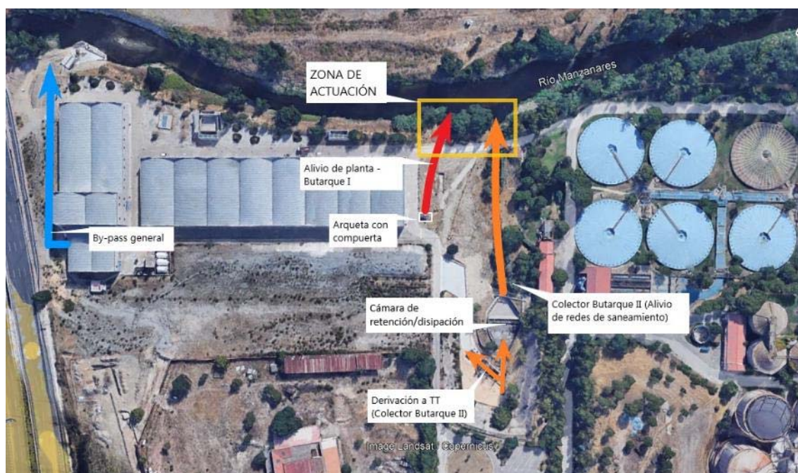
Ilustración 1- Esquema general de los alivios a cauce en la EDAR Butarque.
