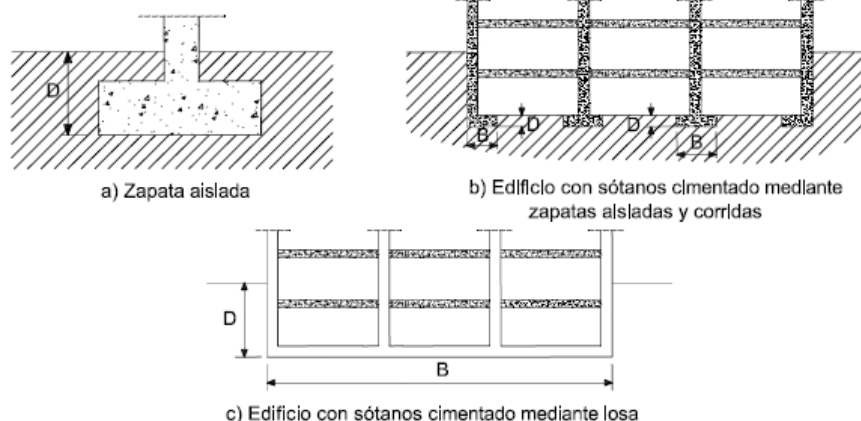
Figura Nº 39.- Profundidad D a considerar en la determinación de la presión de hundimiento
