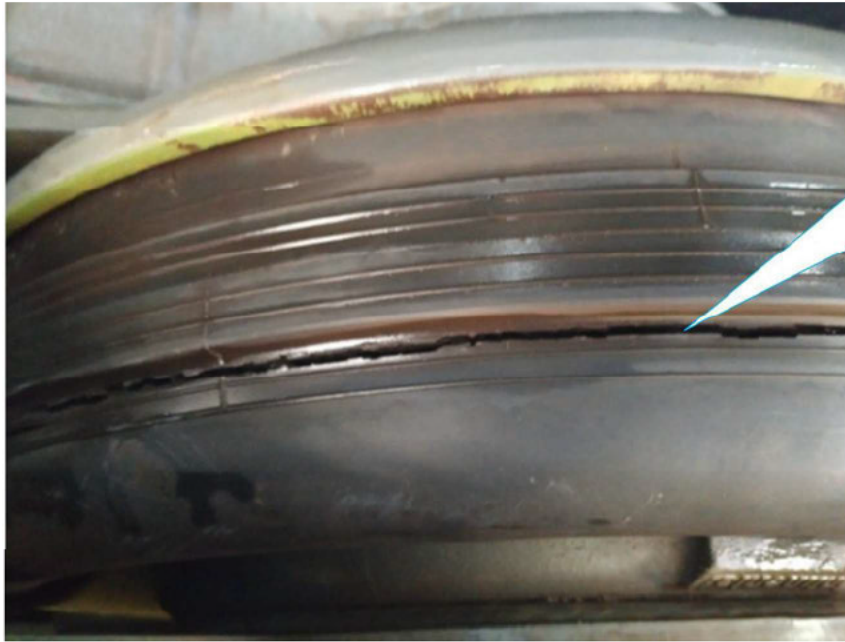
Balona de suspensión con el caucho rajado y con fuga de aire.
