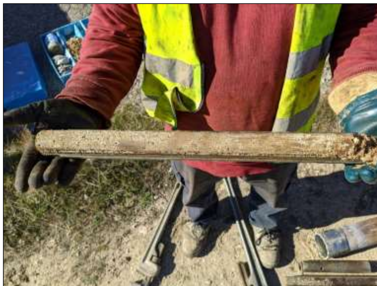
Fotografía 3. SPT. Ensayo de resistencia in situ realizado en el SR-2.
