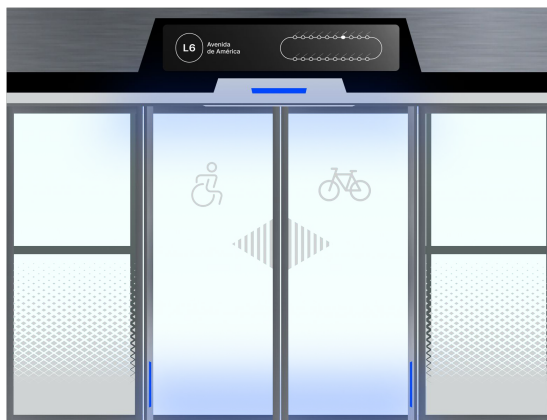
Módulo puerta acceso a tren en estado reposo y pantalla en el cobertor
