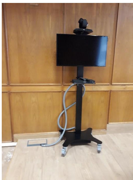
Figura 3 – Ejemplo de sistema de videoconferencia en sala de vistas
