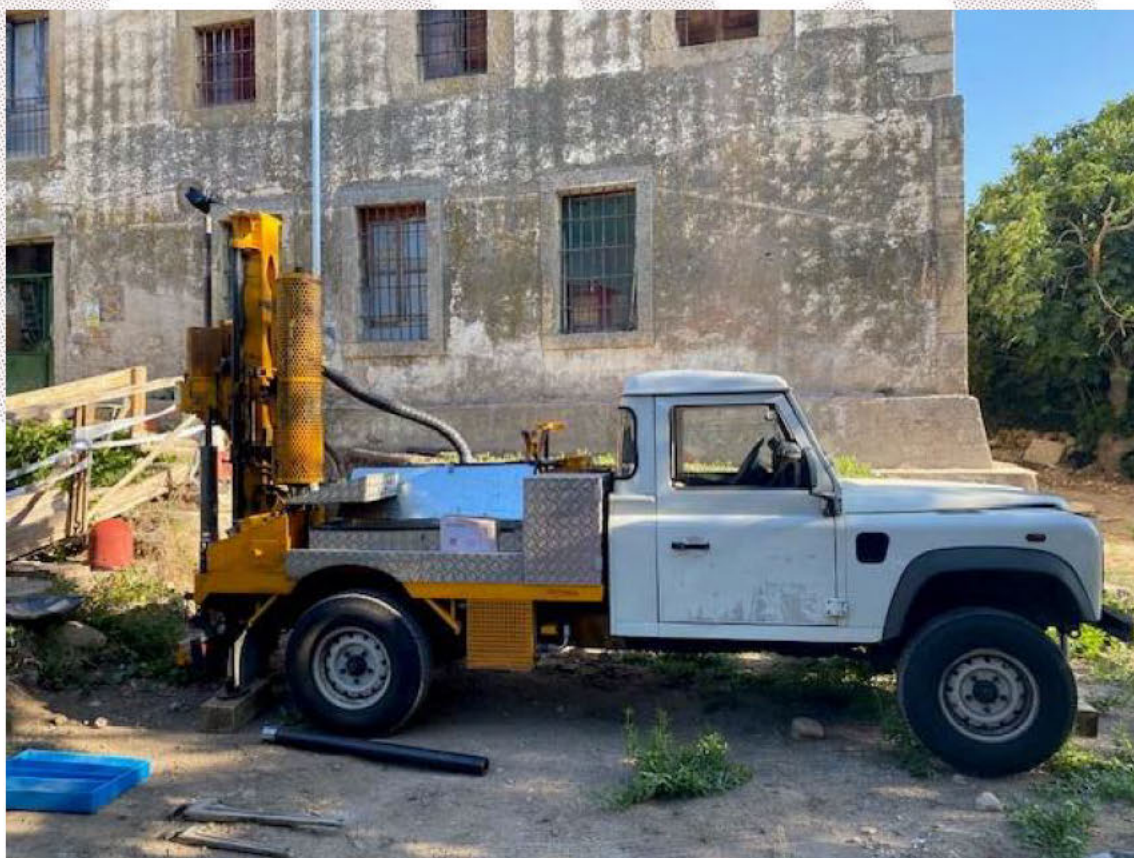
Fotografía 4: Sondeo a rotación nº 1 (S 1) a una profundidad de -6,00 m realizado en la parcela de estudio a fecha de 27/07/2023.
