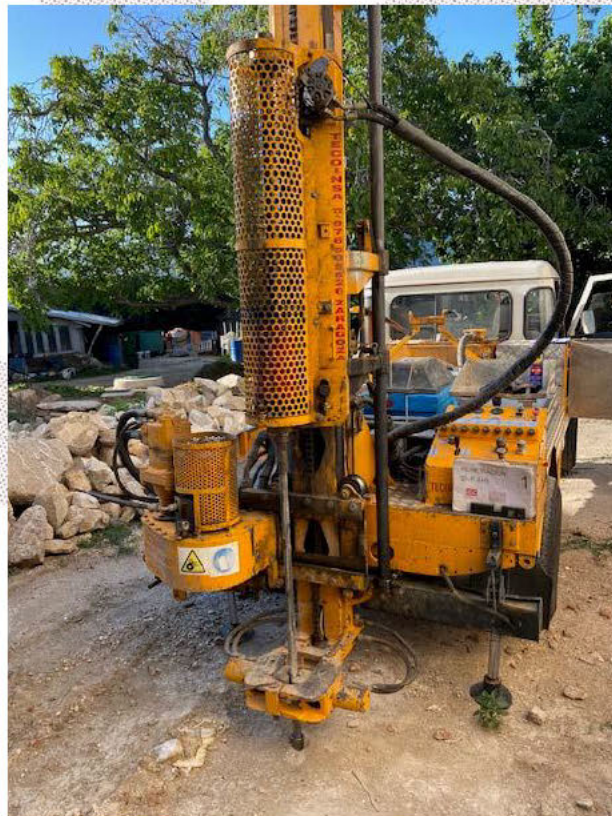
Fotografía 2: Ensayo de penetración D.P.S.H. nº 1 (P1)
