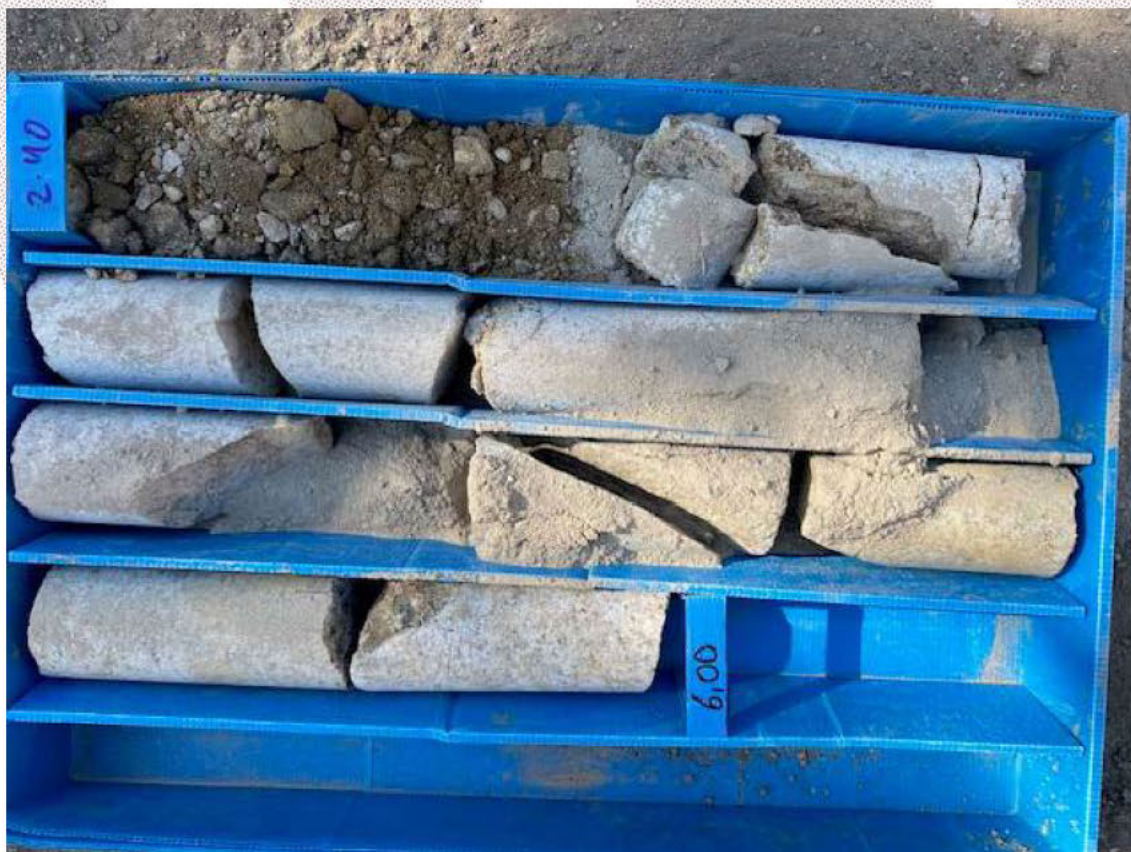
Fotografía 6: Detalle de la caja 2 (tramo de -2,40 m a -6,00 m) correspondiente al sondeo n° 1.
