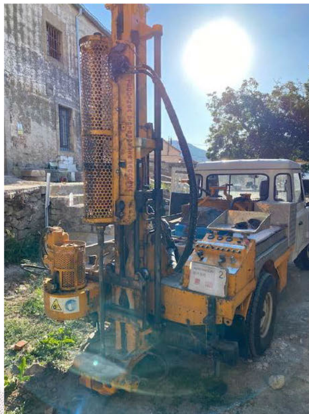
Fotografía 3: Ensayo de penetración D.P.S.H. nº 2 (P2)
