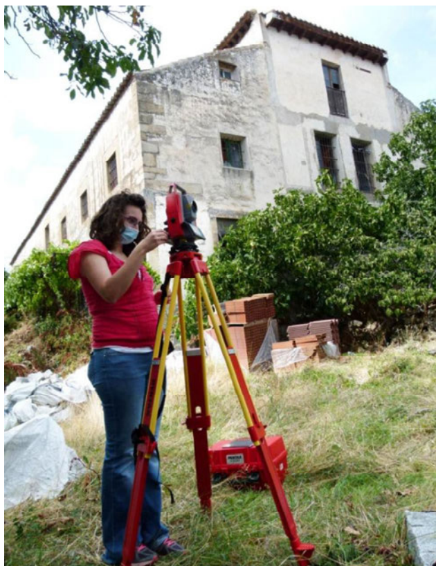
Medición con estación total láser.
