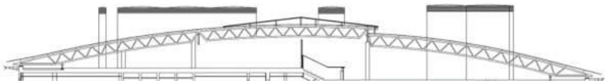
Figura 47- Alzado de estructura de cubierta
