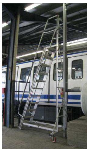
Castillete fijado con dispositivo adecuado
