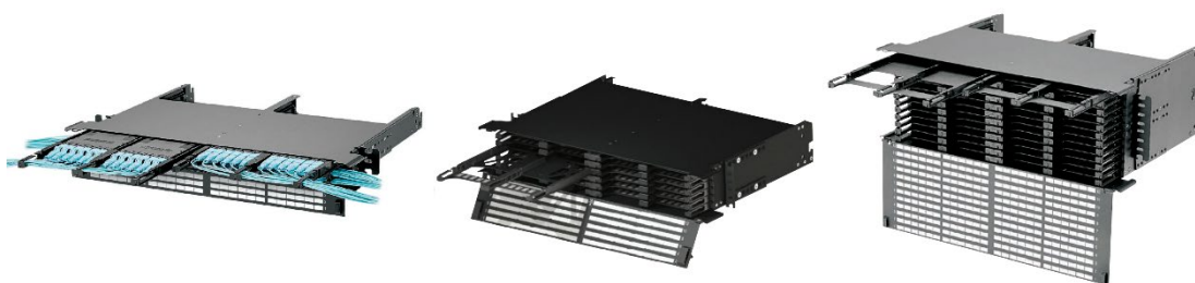
Figura 12: Ejemplo bastidores 1,2 y 4 U (12, 24, 48 casetes de 6 puertos LC dúplex)
