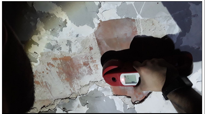
4. Localización de armaduras de vigueta con pachometro
