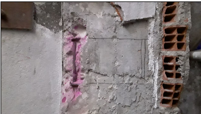
5. Ensayo fenolftaleína. Hormigón sin carbonatar. Detector de armaduras
