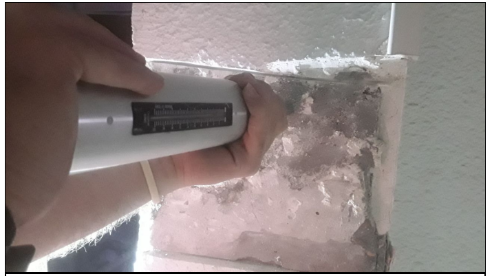
2. Ensayo esclerometrico CP2
