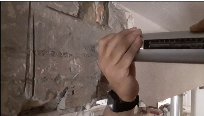
3. Ensayo esclerometrico
