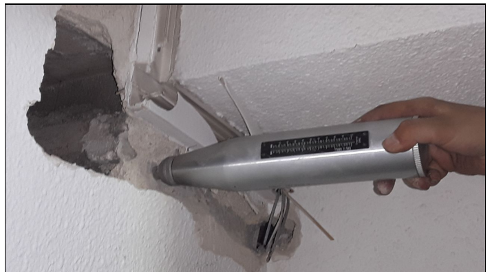
6. CM4. Ensayo esclerometrico.
