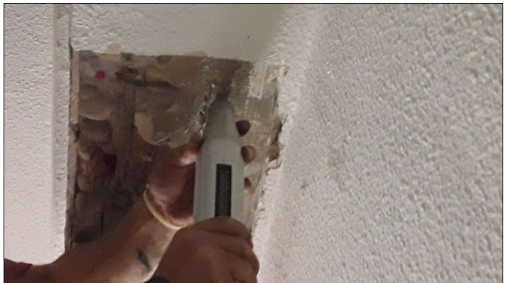
4. Ensayo esclerometrico
