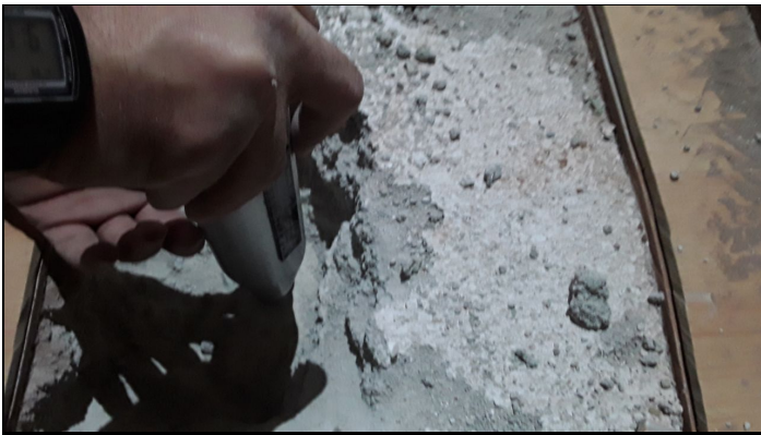
3. CF3. Ensayo esclerometrico
