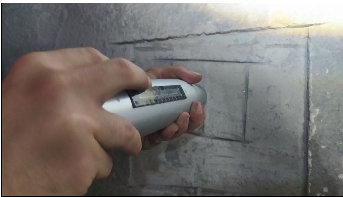
3. Ensayo esclerometrico
