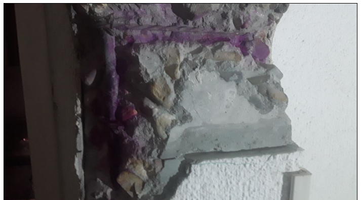
4. CP2. Ensayo esclerometrico. Hormigón sin carbonatar
