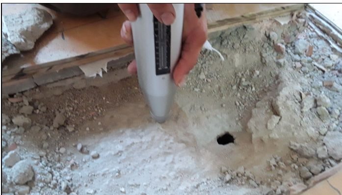
3. CF5. Ensayo esclerometrico
