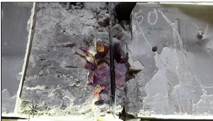
7. CV2. Ensayo de fenolftaleína. Hormigón sin carbonatar
