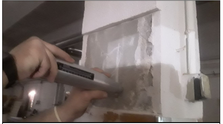
2. Ensayo esclerométrico
