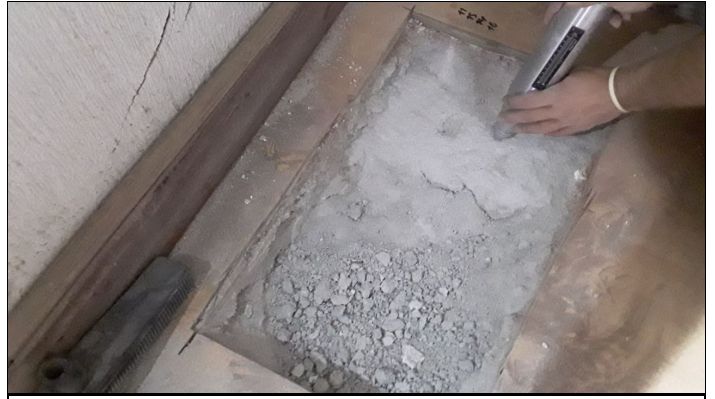
2. CF2. Ensayo esclerometrico
