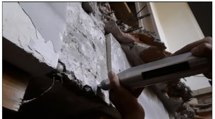
6. CV2. Ensayo esclerométrico
