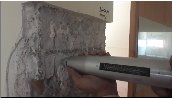
3. CP4. Ensayo esclerometrico
