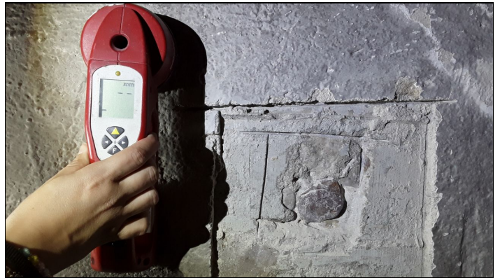
6. No se detectan armaduras
