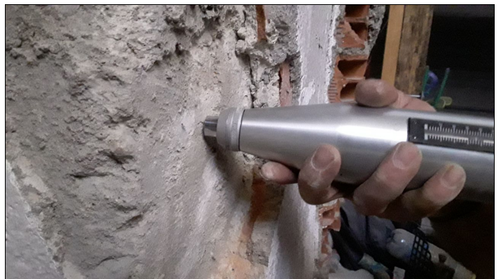
4. Ensayo esclerometrico
