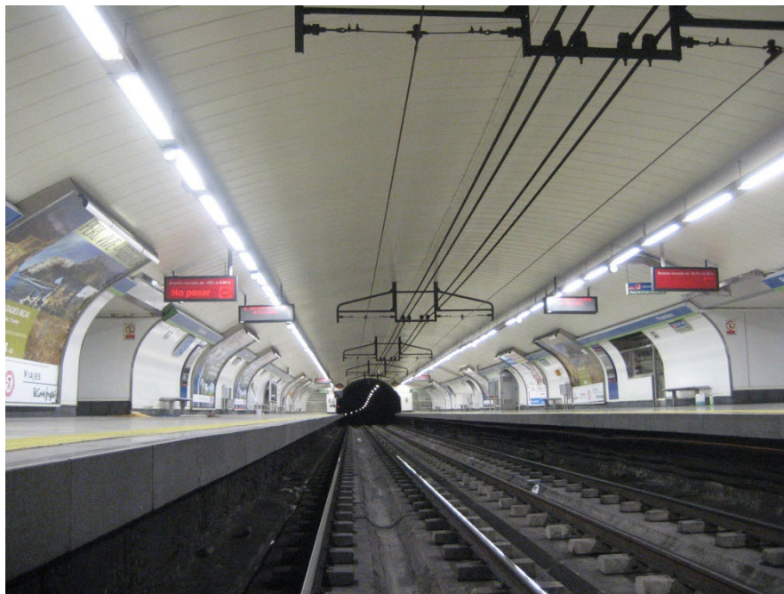
Figura 3: imagen de una estación con hilo tranviario.
