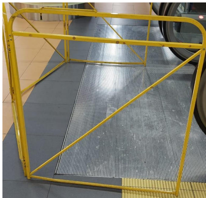
Bastidor de panel actual con un perfil metálico interior, sin guía en U para colocación de cartel
