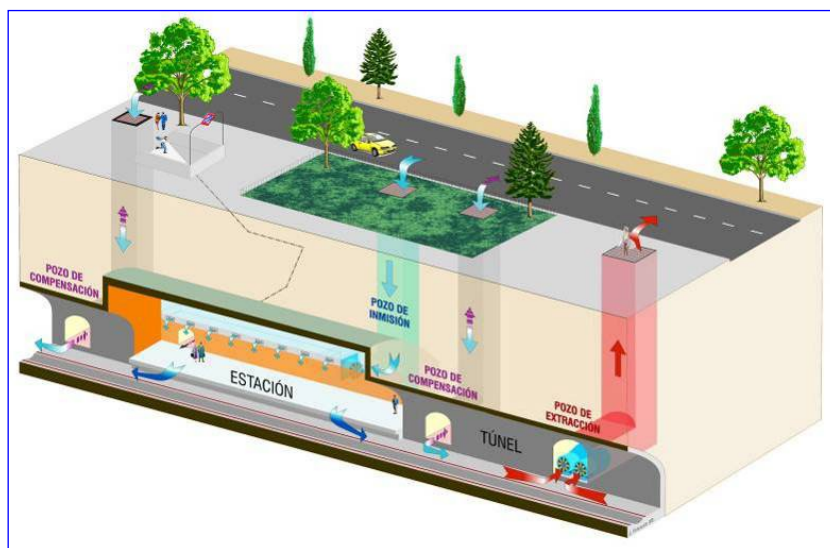
Figura 2 Esquema de diseño-funcionamiento de ventilación
