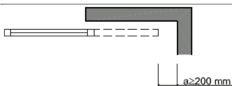
Figura 2.1 Holgura para evitar atrapamientos
