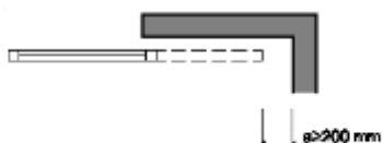
Figura 2.1 Holgura para evitar atrapamientos
