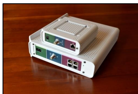
Ilustración 13 Cable modem utilizado en el sistema de recepción
