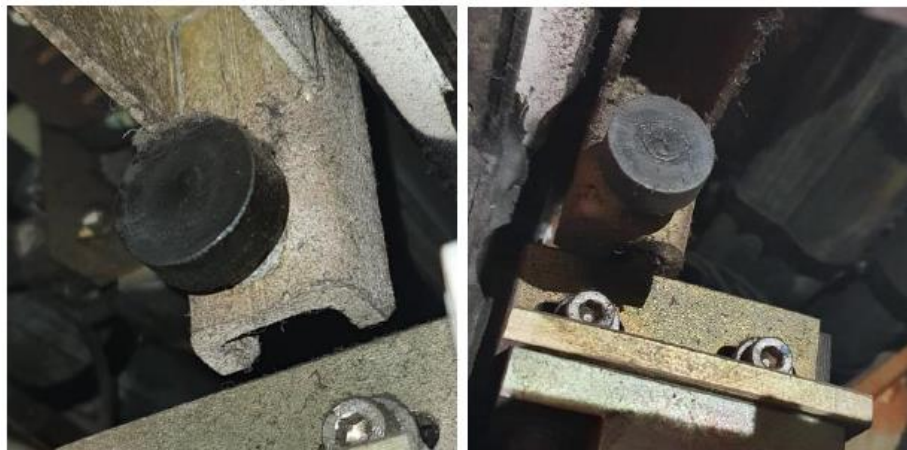
Figura 10. Detalle de los topes finales de carrera de apertura de puerta.
