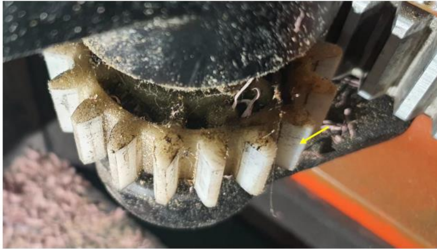
Figura 6. Detalle del estado de los piñones.
