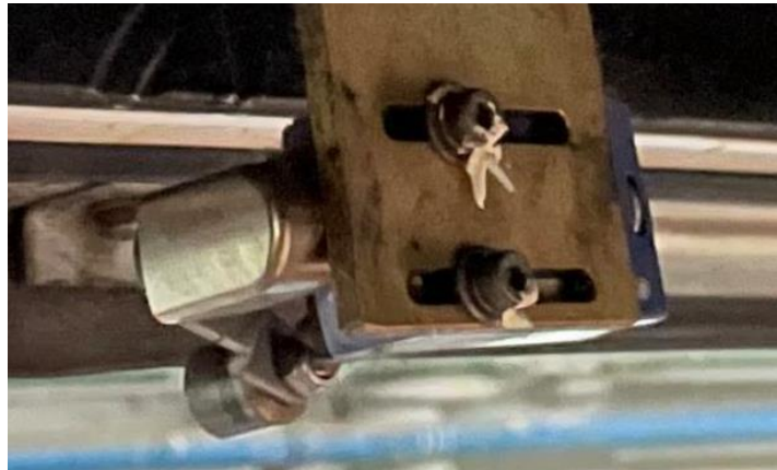
Figura 9. Detalle del interruptor de final de carrera del pico de loro
