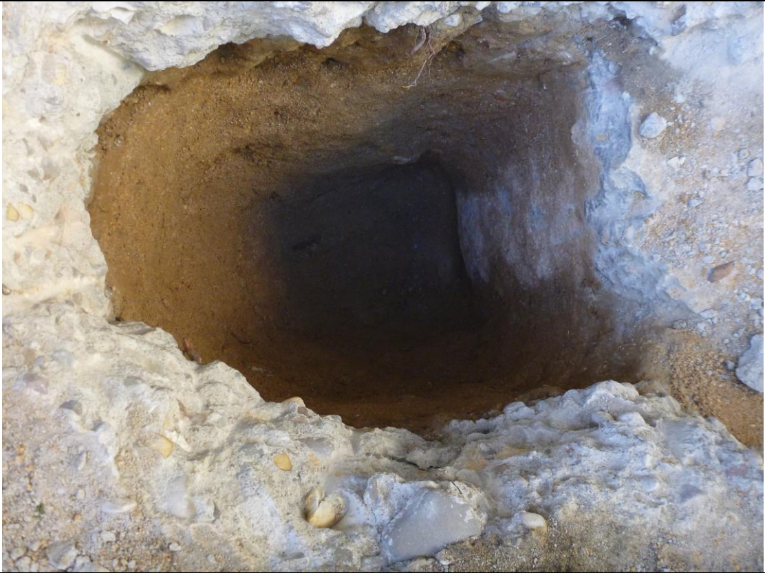
FOTOGRAFÍA 10. Calicata CC.02. Fondo de excavación. Apoyo de zapata.
