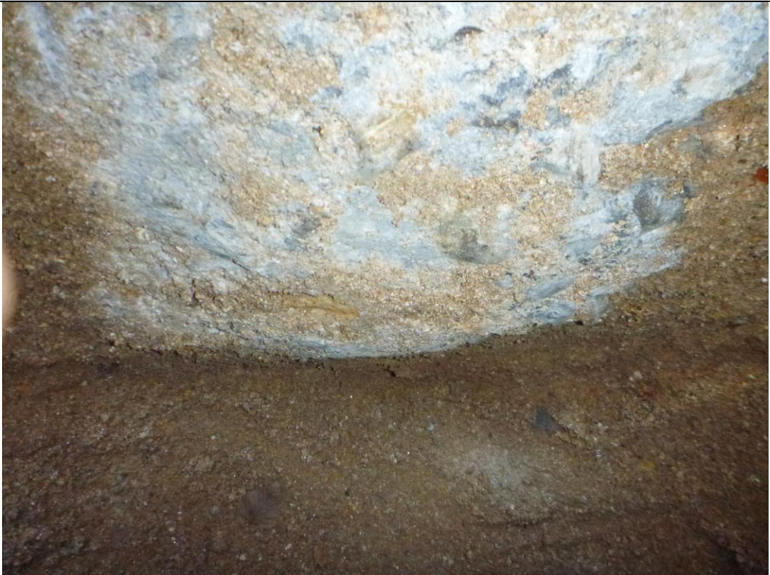
FOTOGRAFÍA 10. Calicata CC.02. Fondo de excavación. Apoyo de zapata.
