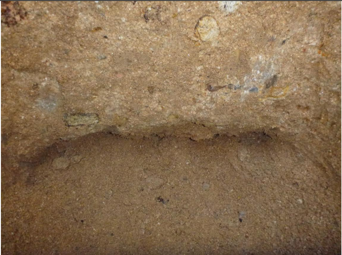
FOTOGRAFÍA 06. Calicata CC.03. Fondo de excavación. Apoyo de zapata.
