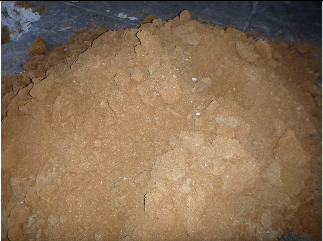
FOTOGRAFÍA 26. Calicata CC.06. Terreno extraído. Aparentemente tosco.
