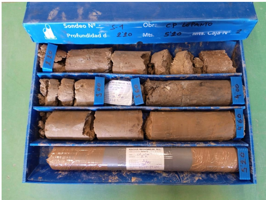
Sondeo S-1, caja 2, de 2,20 m a 5,20 m de profundidad.
