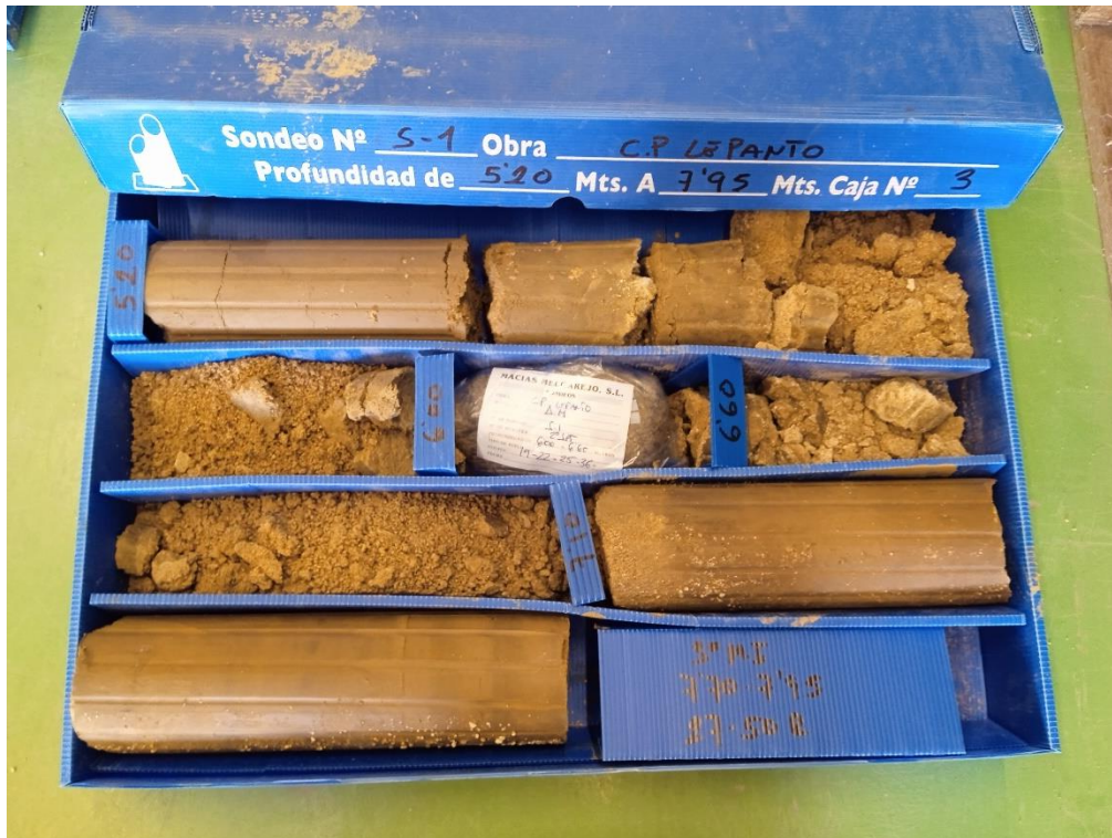
Sondeo S-1, caja 3, de 5,20 m a 7,95 m de profundidad.
