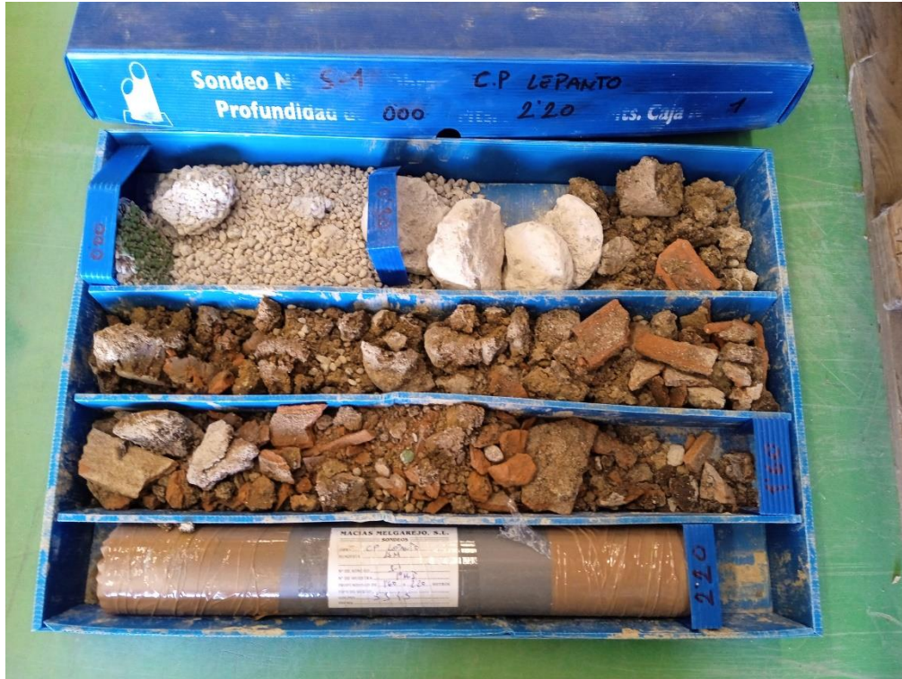
Sondeo S-1, caja 1, de 0,00 m a 2,20 m de profundidad.
