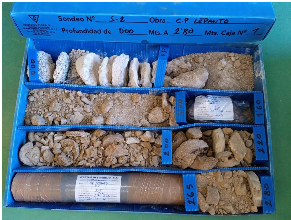
Sondeo S-2, caja 1, de 0,00 m a 2,80 m de profundidad.
