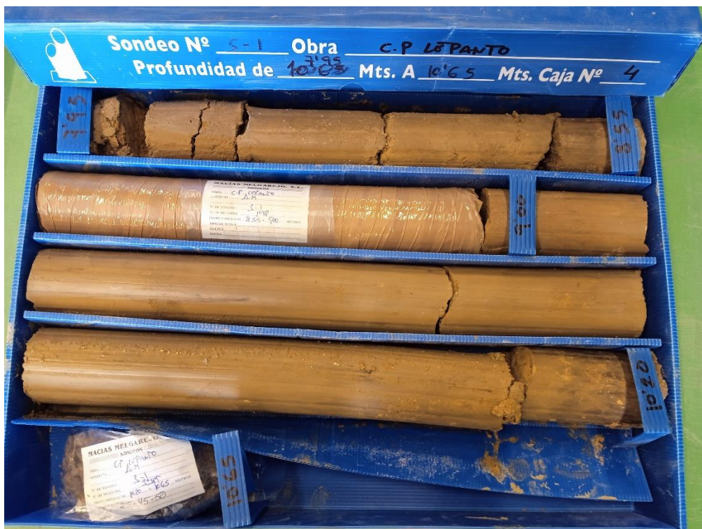
Sondeo S-1, caja 4, de 7,95 m a 10,65 m de profundidad.
