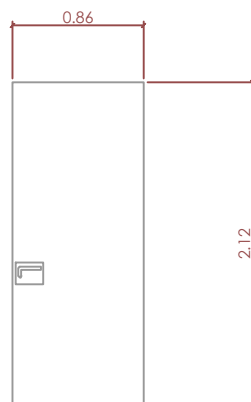
V2. Puerta madera abatible enrasada y panelada Dibond color RAL 9006 por el exterior y blanco caolín por el interior (1 ud)
