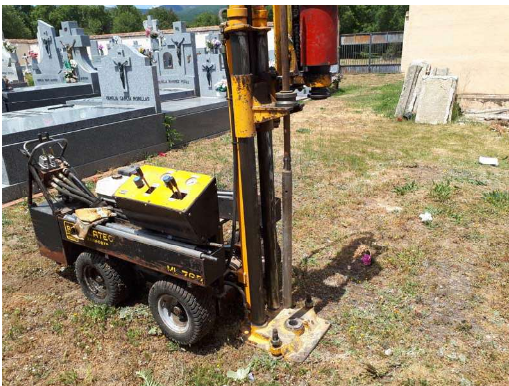
Fotografía 2: Realización de la penetración dinámica DPSH, P-1.
