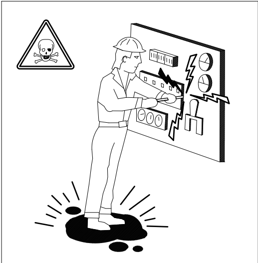
REPARACIÓN DE EQUIPOS BAJO TENSIÓN
