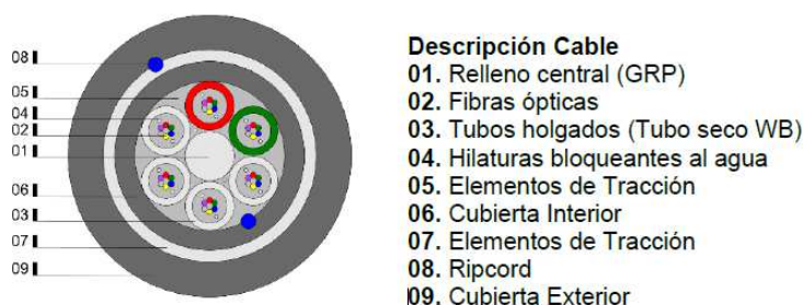
Figura 1: Construcción básica cable de fibra óptica
