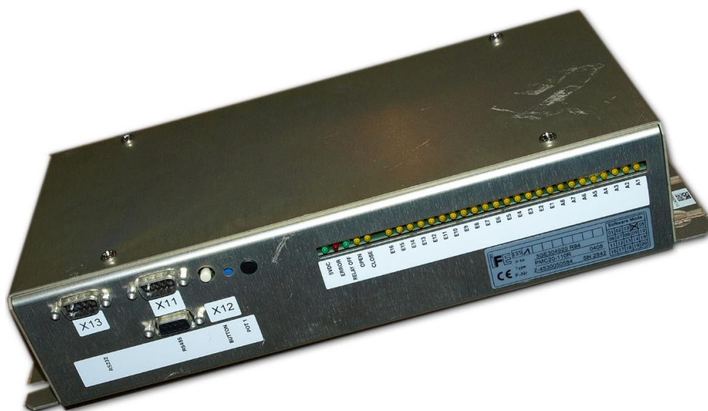
Tarjeta control puerta PMC20-100R coches 3000 (DCU).
