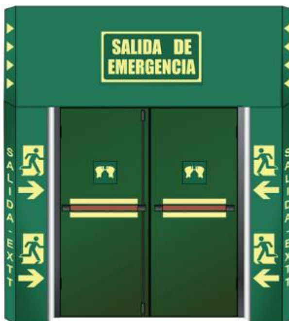
Fig. 15 – Pórtico salida emergencia túnel
