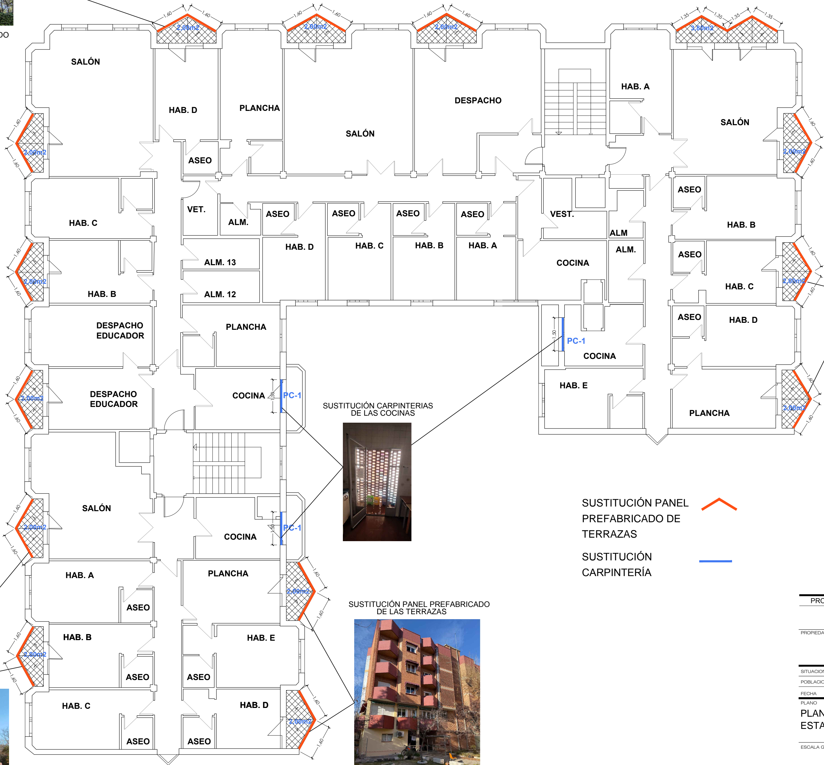
SUSTITUCIÓN PANEL PREFABRICADO DE LAS TERRAZAS EN FACHADA ESTE
