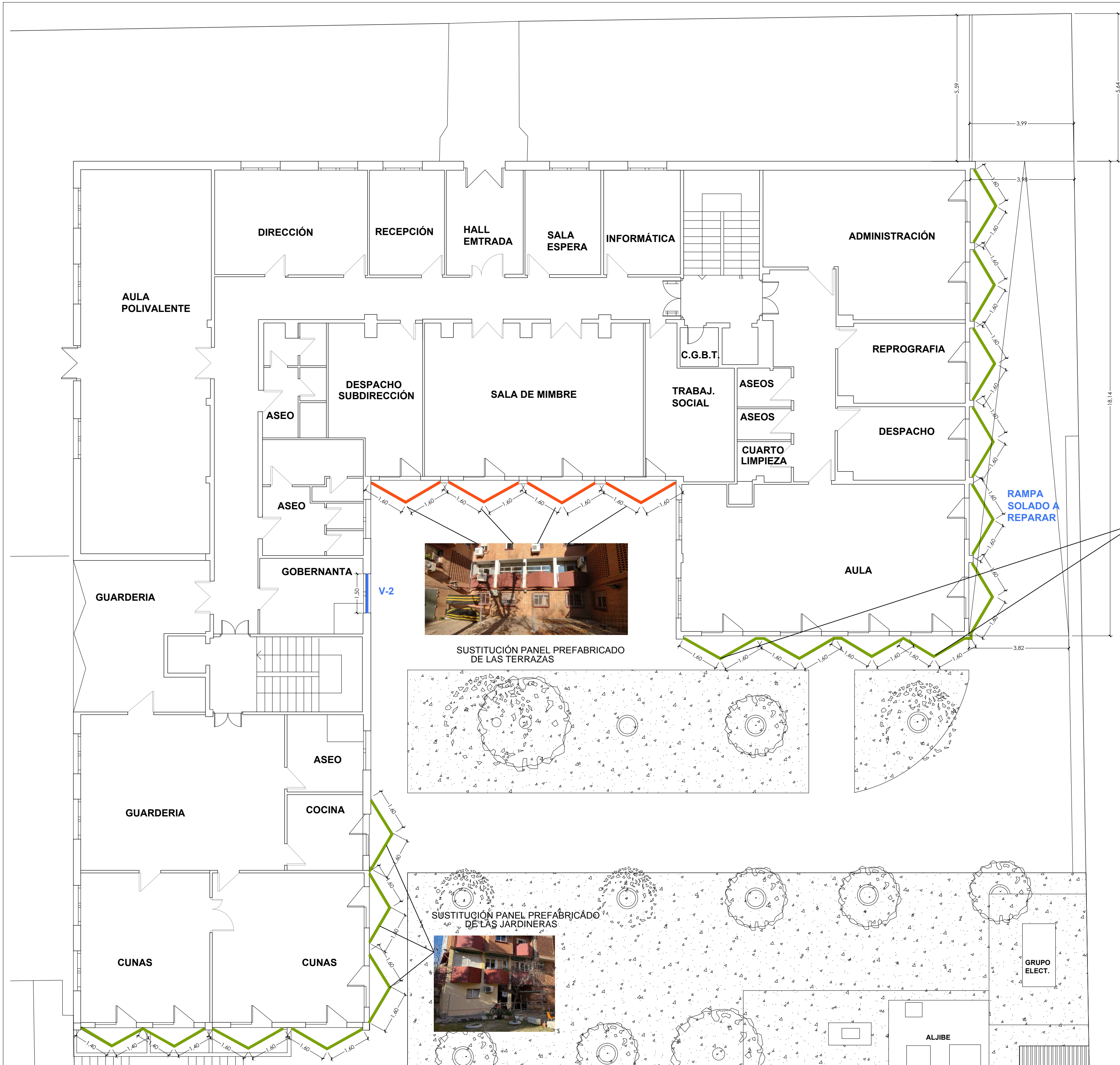
SUSTITUCIÓN PANEL PREFABRICADO DE LAS JARDINERAS
