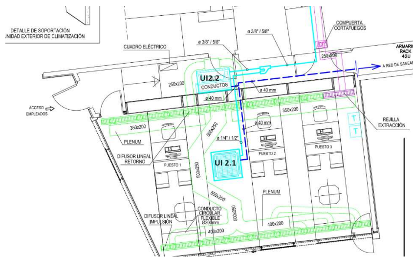
Ilustración 4.: Ubicación de las unidades interiores
