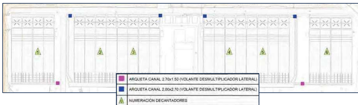
Imagen 3: Planta de ubicación de compuertas canal de aislamiento hidráulico de los decantadores.
