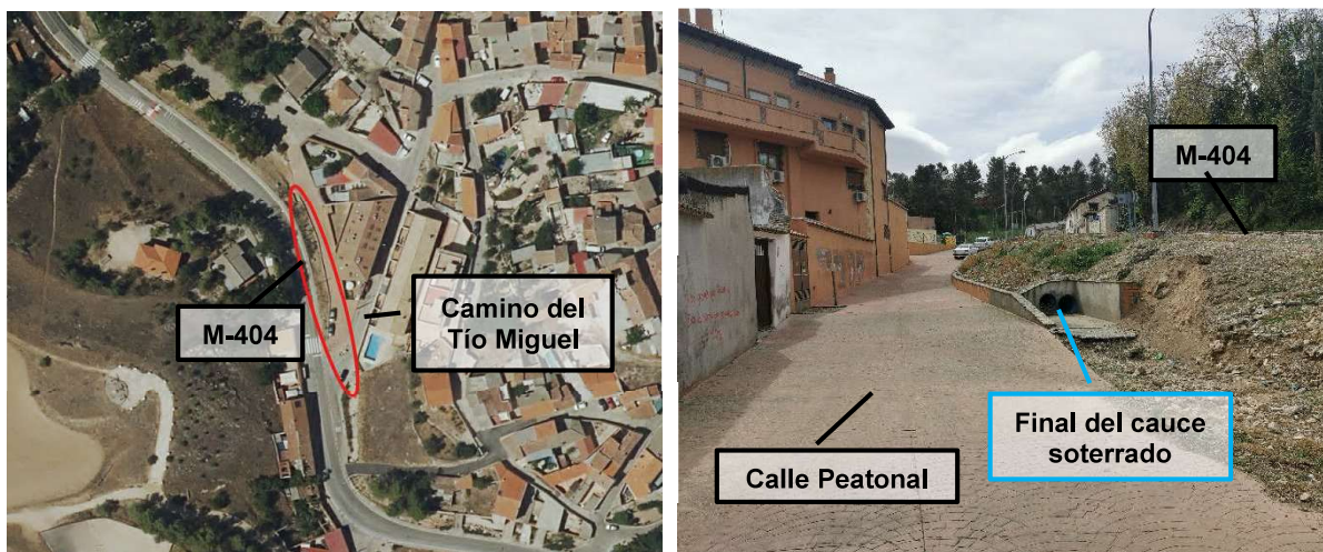
Figura 3- Tramo de cauce soterrado.
