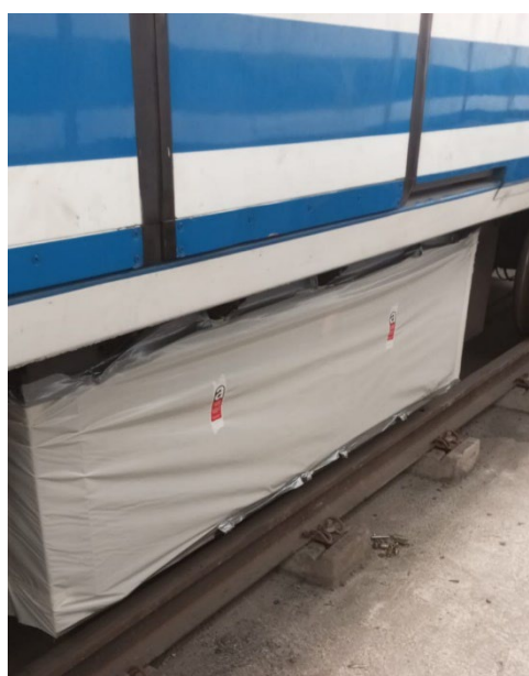
EJEMPLO DE CONFINAMIENTO EN COFRES BAJO BASTIDOR
