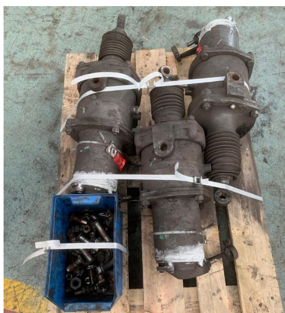
EJEMPLO DE ESTABILIZACIÓN DE MCA EN CILINDROS DE ESTACIONAMIENTO
