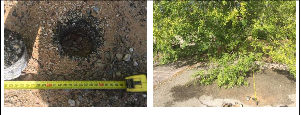
Detalles de espesor, estructura interna, capa base de pavimento y espesor de testigo, y ubicación del testigo 1
