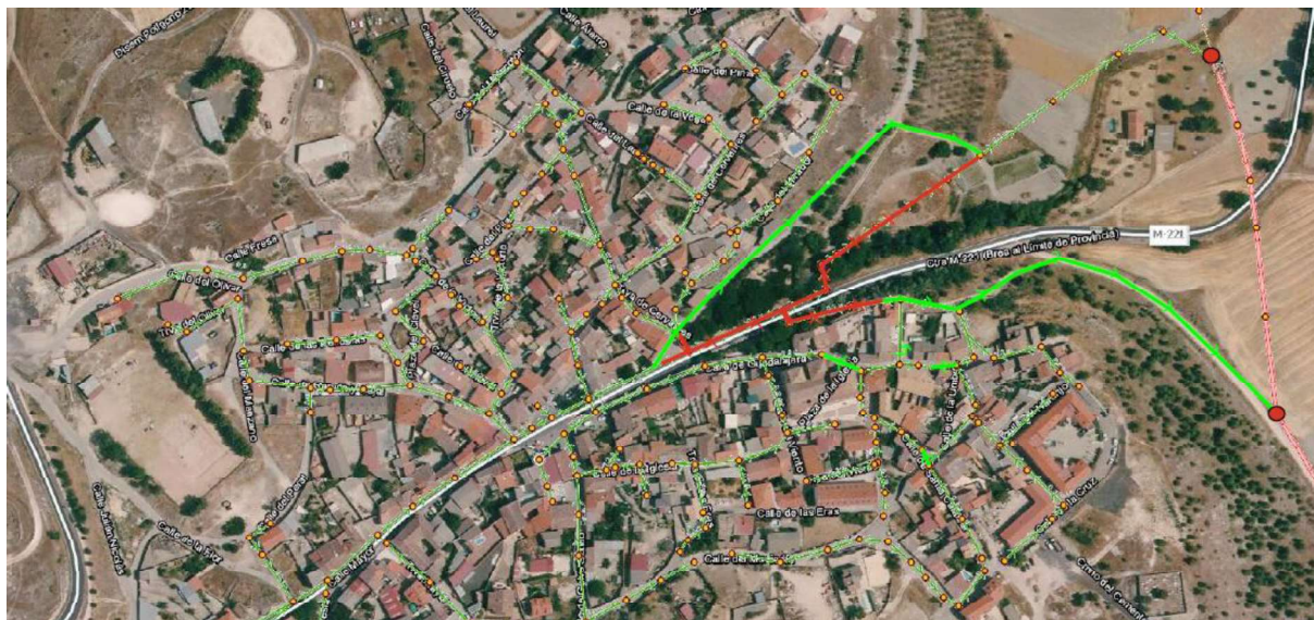
Foto 2. Colector interceptor principal (verde) y colector anulado (rojo)
