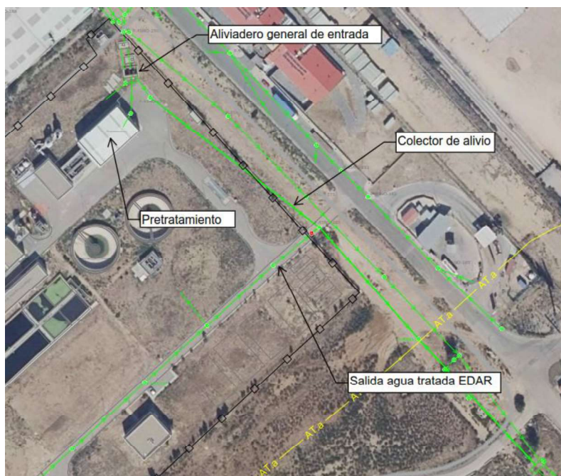
Aliviadero entrada EDAR y red de tuberías de saneamiento (ALV.45NO-242)
