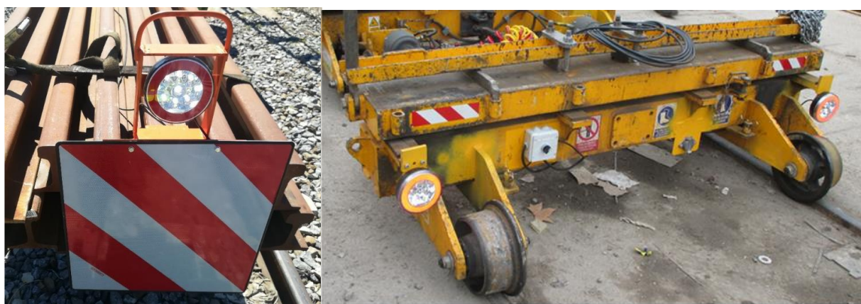
Imagen 5. Señal luminosa y cartel señalizador V-20 (imagen de la izquierda) y conjunto de luces de posición (imagen de la derecha).
