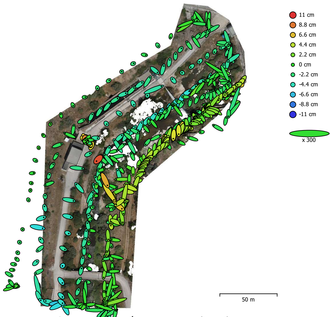
Fig. 3. Posiciones de cámaras y estimadores de error.
