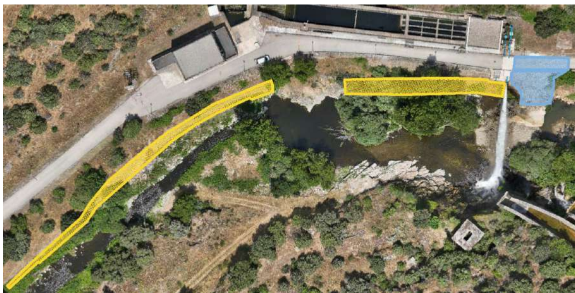
Figura 2: Zonificación de los trabajos (Amarillo: zona muro de gaviones; Azul: Zona desprendimiento)
