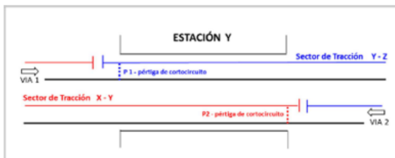
Esquema general de situación de Sectores de tracción en estación, en la que haya establecido un cambio de sector de tracción.
