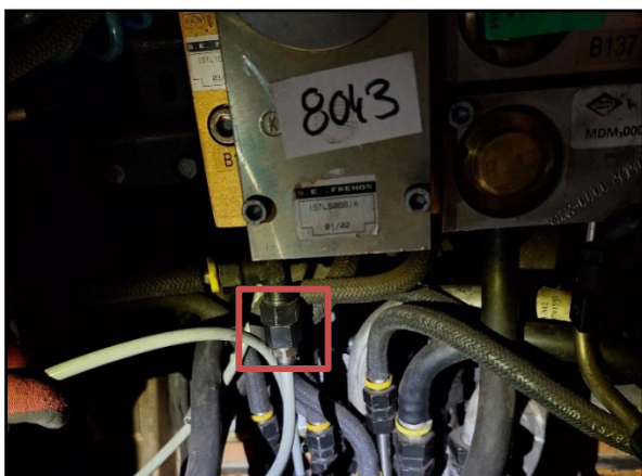
Figura 5. Ubicación conexión tubo recto legris con panel neumático.
