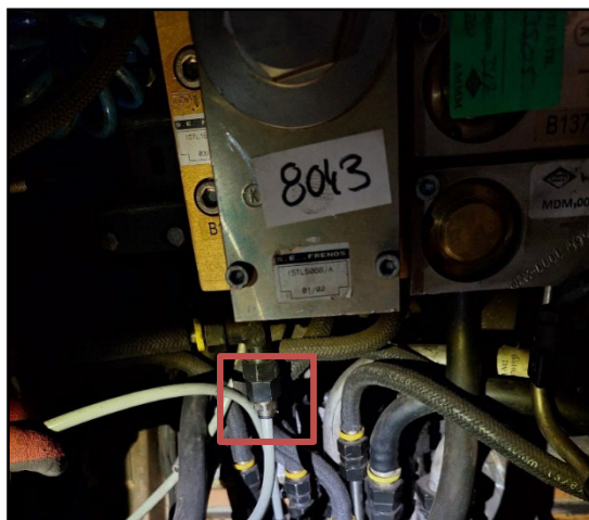
Figura 12. Ubicación conexión tubo recto legris con panel armario neumático (presión freno).
