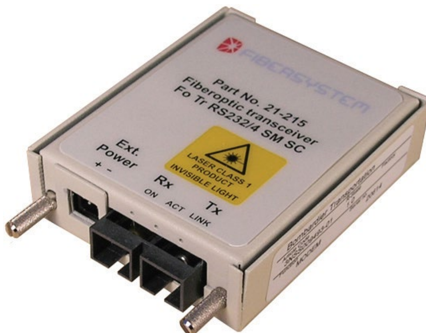
Imagen 1. Conversor RS232-FO utilizado para la comunicación RATP-IPU de CBTC-BT
